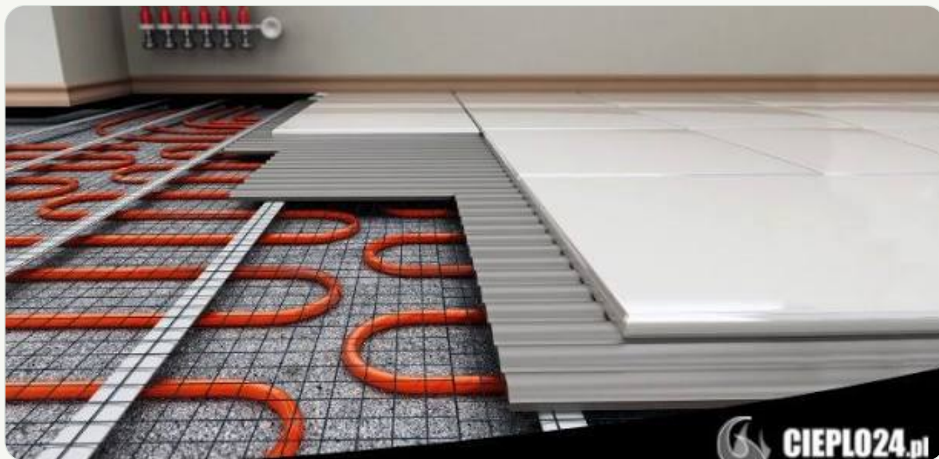
Wodne ogrzewanie podłogowe: przykładowy układ rur i warstw. Materiał ilustracyjny z oznaczeniem źródła na grafice.
